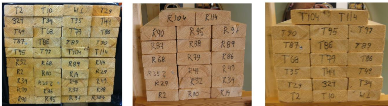
Figur 18. Uppdelning av virkespaket med 20,5 % startfuktkvot för tomografering.
