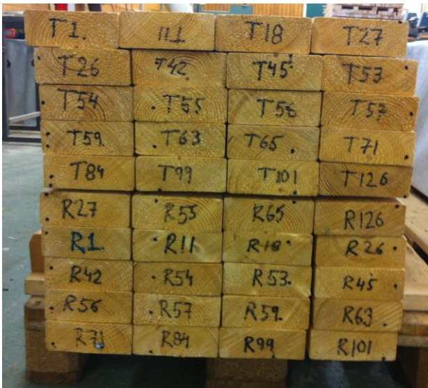
Figur 9. Paketet med 20,5 % medelfuktkvot efter lagringen. Märkning "T" och "R" skrivet i topp- respektive rotänden av varje plank.
