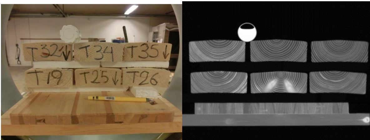
Figur 21. Sex torrviktsprover placerade i tomografen och torrviktsprofil från scanningen.
