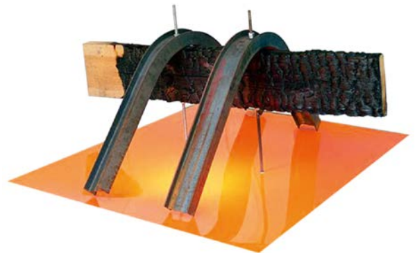
Limträ behåller till skillnad från oskyddat stål sin bärförmåga vid brand.
