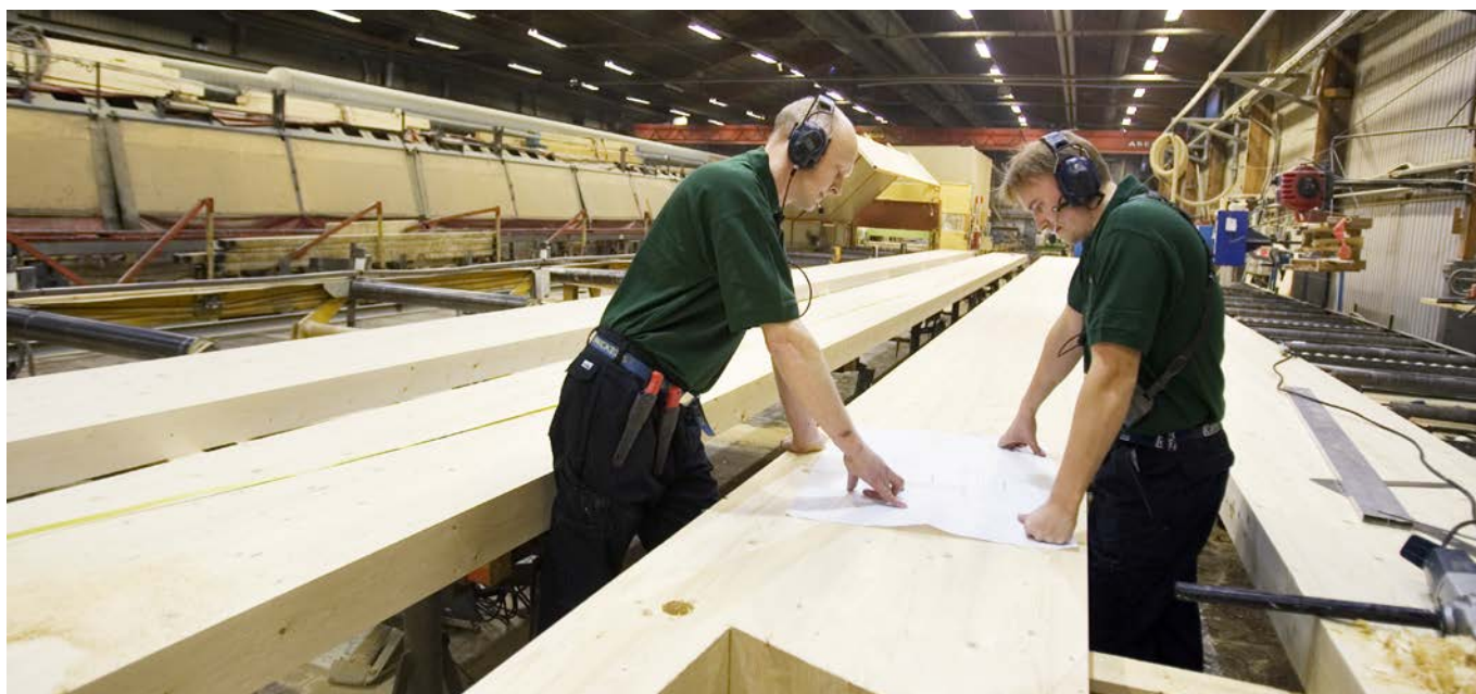
Limträ tillverkas industriellt under kontrollerade former. Fotot visar efterbearbetning av limträbalkar.
