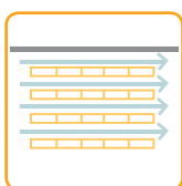
Strölägg limträet om det blivit fuktigt
